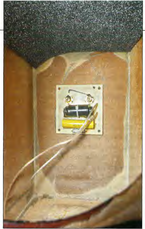
Im Inneren gibt's den auf der Rückwand montierten Sperrkreis und ganz wenig Dämmmaterial
